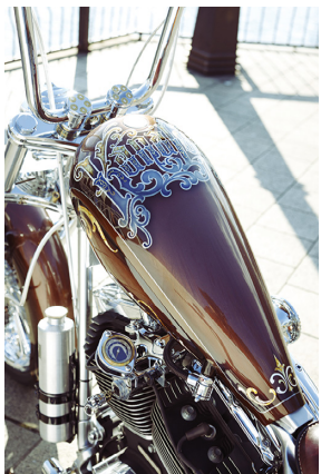
サーファーというオーナーに合わせて海をイメージさせるデザインでロゴを描く。ペイントはナチュラル。メーターステーはエキゾーストフランジを加工したもの
