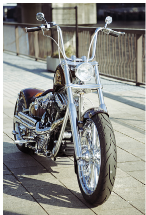
ハンドルはミディアムスクーパー。ライトはRSD。アクトロニクスのツリーは見た目だけでなく2インチオーバーのフォークをレイクさせる役割も担う
