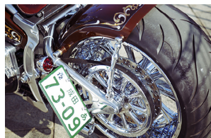
PMのワンサイドドライブブレーキでリアホイールはスッキリ。テールライトはオールドスタイルだがLEDを内蔵する優れモノ
