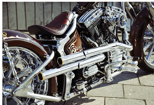
ミッドコントロールはダイナ用を流用加工。オイルタンクはフレーム幅に合うよう作り直されている。スイングアームはPMのファッティルキットを用いる
