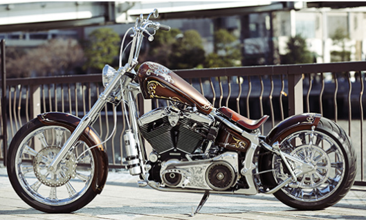
2インチストレッチしたフォークはツリーで寝かせてある。前方が持ち上がるフレームに対してマフラーは地面と平行にすることでロイヤルへのフォルムを作り出している
