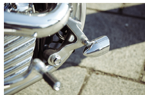
本来フォアコンのステーが残る部分はウインカーステーとして丁寧な整形が施される。各所にこうしたモディファイが施されカスタムフレームのような表情に
