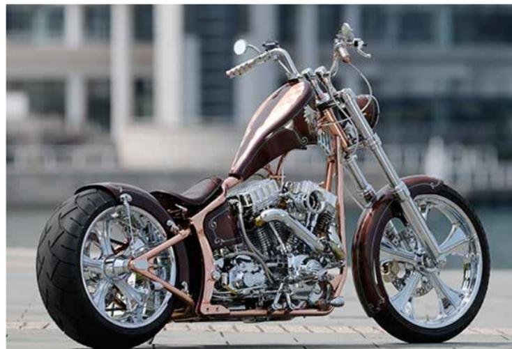
さらに、「作り手は乗り手であることが大切」という鈴木さんの言葉の通り、作り手が普段から走っている中で経験からくるディテールが落とし込まれている。工具なしで外せるシートや、バンク角をかせぐためにフレームに対して斜めにつけられたステップマウント、パーツを足せば後からでも高さが変更できるオリジナルライザーなど気の利いたディテールは明らかに乗り手の視線から生まれているのだ。ビッグモーターには好みがあるけれど、オーナーとやり取りを重ねた結果、この車両に組んだのはS&Sツインカムのみ
