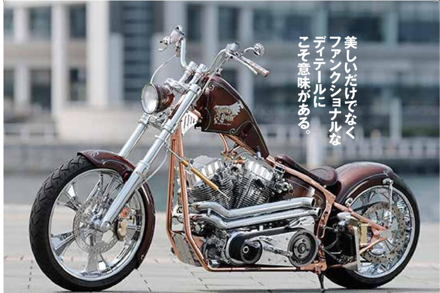
フレームはやや前方にストレッチすることで、フレームの下のラインが地面に水平になり、且つネックからアクスルまでのラインが一直線になるように設計されている。それによって、極端にローダウンしてサスペンション機能を失わなくても、ソフテイルフレームの性能を残したままで、美しい三角形のシルエットを手に入れている
