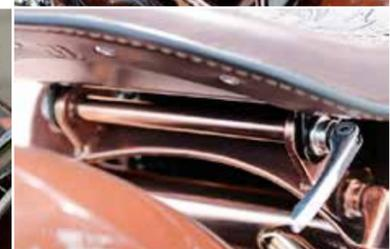
自転車のサドルのパーツを流用して、シートは工具を一切使わずに外せる仕様。シャフトにオーリングをかませることで走行中の安定感も◎
