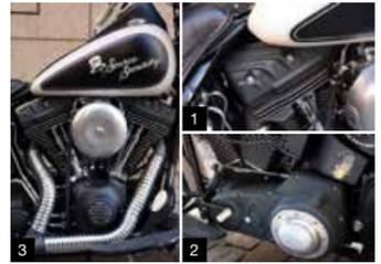
エンジン周りはヴィンテージのギラつきと対比的に、質感を落としてアンティークのような雰囲気。1.2.ロッカーカバーとプライマリーカバーはEMDの鋳物に交換。3.タンクやエアクリナーもツヤを抑えることで、全体として統一感のある仕上がり
