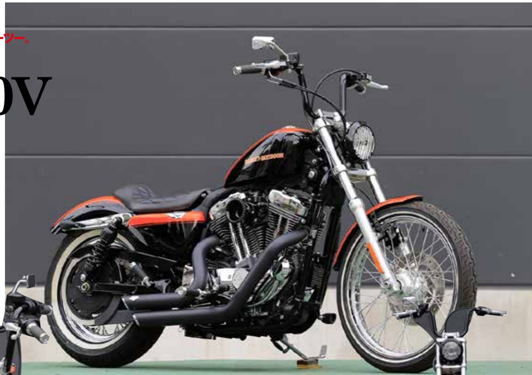
エンジンは基本的にストックでフラッシュチューナーを使いチューニングしている。ハンドルはオリジナルのミニスクープバーのブラックの8インチ。リアショックはプログレッシブ製444でローダウン
