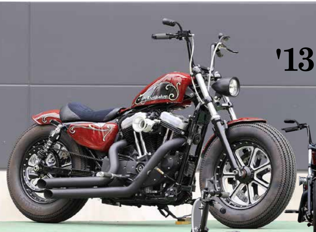
ヴィンテージスタイルでハイトのあるタイヤが入るように純正フロントフェンダーはマウント位置を変更。リアフェンダーはワンオフで48のスタイルを崩さないようにタイヤの太さと大きさを強調している
