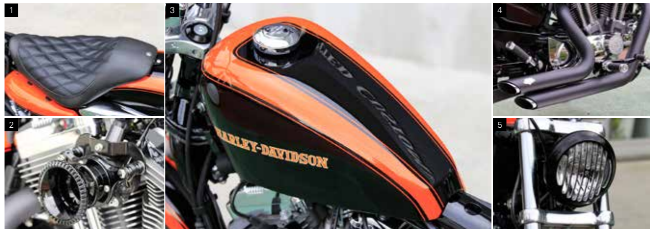
1: ソロシートはローランドサンズデザイン 2: オリジナルのデュアルスロートベロシティスタックキット。2次吸気用の穴がサイドにあり吸気効率が向上 3: セブンティーツー純正のタンクをオレンジ&ブラックのファクトリーカラーに塗装 4: マフラーはバンス&ハインズのショートショット。サイレンサーを加工して音量を抑えている 5: ヘッドライトはパフォーマンスマシン。ブラックで引き締まった印象を与える
