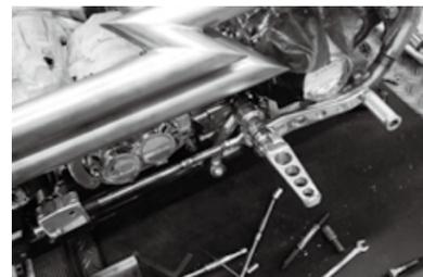
ブレーキ側はフレームにベグをマウントする方式で、サンダーバイクのフォアコンを流用してミッドコントロールを作ります
