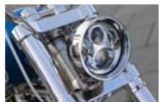
ビレットのライトケースに大人気の純正LEDを加工して埋め込み。さりげなくハーレーのロゴが入るのが嬉しいのです
