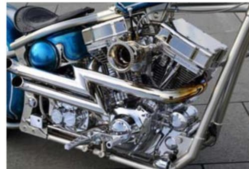
エンジンはアメリカのチューナーの下で一から組み直され恐ろしくスムーズ。スーパーGにオリジナルのファンネル。セレクトッドのロゴをモチーフにしたSショットマフラーは、2インチ径のヒートガードと1-3/4パイのマフラーとを全く同じ形状で作らなければならない高度な技術を必要とするもの
