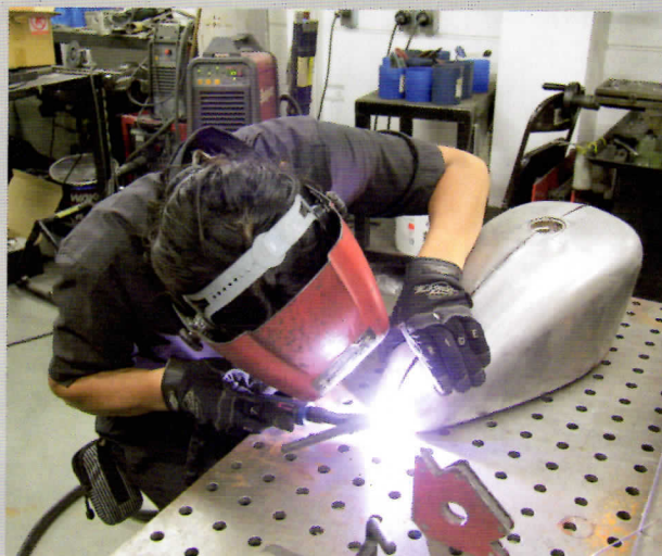
ナローにするため、真っ二つにしたスポーツスタータンクを溶接している鈴木氏の姿。マシンの製作はもちろんのこと、エンジンチューンからワンオフパーツの製作まで行っている
