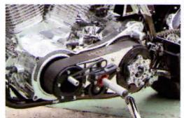
124cuiデルクロンヘッドエンジンを搭載する事で、ベルトドライブやトランスミッションなども強化されている
