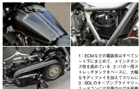
1: ECMなどの電装系はすべてシート下にまとめて、メンテナンス性を高めている 2: バガー用ストレッチタンクをベースに、大幅なモディファイを加えてスリムに 3: BDLのオープンプライマリー。ミッドコンには今風のベグを装着
