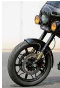
フロントにはオーリンズの倒立フォークとブレンボのラジアルマウントキャリパーをセット。リアにもオーリンズのブラックラインを装着して、T143のビッグパワーをしっかりと受け止める足まわりにグレードアップする
