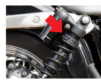
付属レンチでスプリングの締め具合を調整して固さを変える
