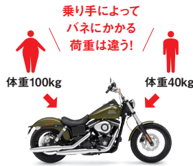
付属レンチでスプリングの締め具合を調整して固さを変える
