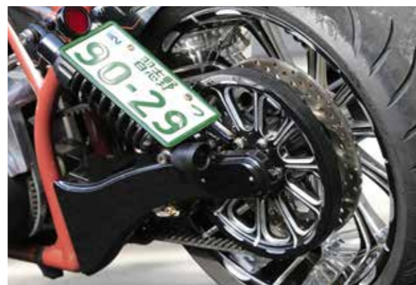
18インチPM製レベラプラチナムカットホイールに240mm極太タイヤを装着。ビッグマシン製スイングアームはセレクトッドがデザインし、フレームと同じ幅に
