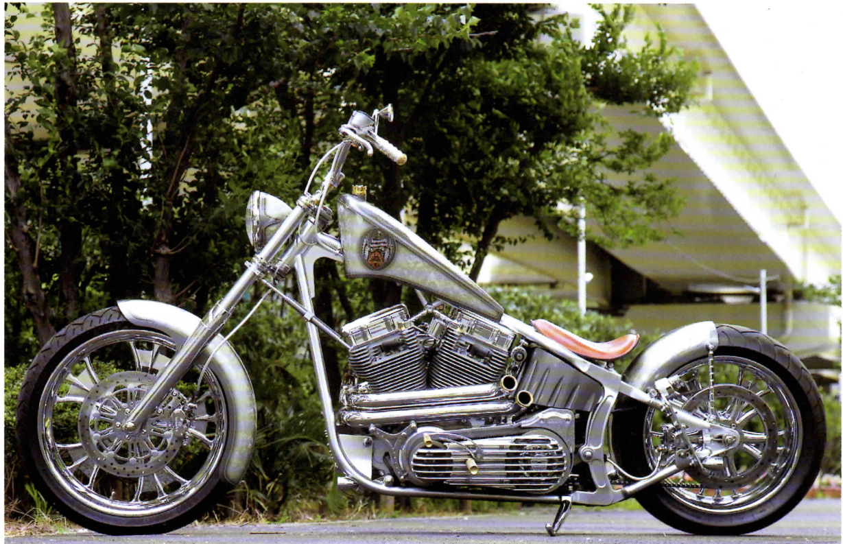
2001年FXSTをベースにし、バックボーンとダウンチューブが2インチづつストレッチされたこの一台。まさに王道のスタイルである。
