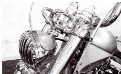
ヘッドライトは、トリプルツリーからの吊り下げタイプのマウントになっているので、正面から見ると宙に浮いているように見えている。目立つパーツの一部なので、外装塗装を少し加えてマッチングラ〜
