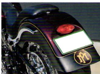
スイングアームはPM製ファテイルキットを装着。純正リアフェンダーをモディファイして、キャッツアイのLEDテールライトを埋め込んだ。ペイントが統一感を出している
